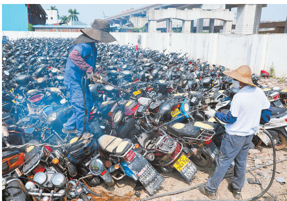
有关人员对摩托车的大梁、车牌进行切割。
